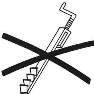
10. **VIKTIG!** HUSK Å TA UT PARKERINGSSTAGET FØR HYDRAULIKKEN LØFTES. Staget brukes BARE til parkering. Hvis dette glemmes vil staget rives i stykker p.g.a. parallellforskyvningen som oppstår mellom lunneplata og festet når hydraulikken løftes.
