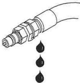
3.2.6 - (N) Kontrollér at ingen lekkasje av hydraulikkolje finnes
