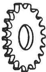
Es gibt verschiedene Typen Kettenrad. Indem ein Kettenrad gegen ein grösseres/kleineres Kettenrad getauscht, kann man die Geschwindigkeit des Stahlseiles einstellen.
