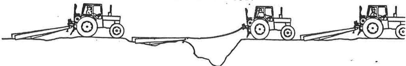
Treten Schwierigkeiten während der Fahrt auf, kann das Holz nach Öffnen der Bremse liegenbleiben und in der Flucht wieder nachgesieilt werden.
