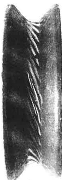
*Bilde nr. 13. Blokk med stor sporslitasje etter ståltau.*
